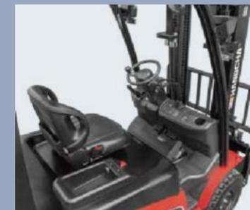
Spazio della piastra operativa completamente chiuso, cilindro inclinabile e piastra inferiore piatta, per un funzionamento più comodo e sicuro
