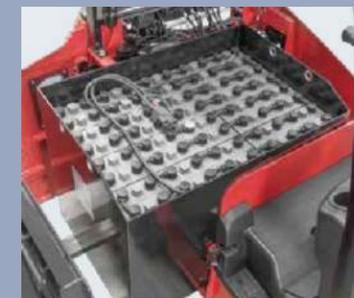
L'estrazione laterale della batteria tramite rullo offre una soluzione rapida, semplice e sicura per l'operatore
