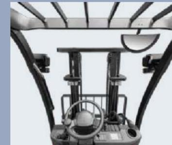
Il nuovo albero progettato e il grande tetto in acciaio aperto offrono una visibilità eccellente, inoltre possono ridurre il rischio di incidenti
